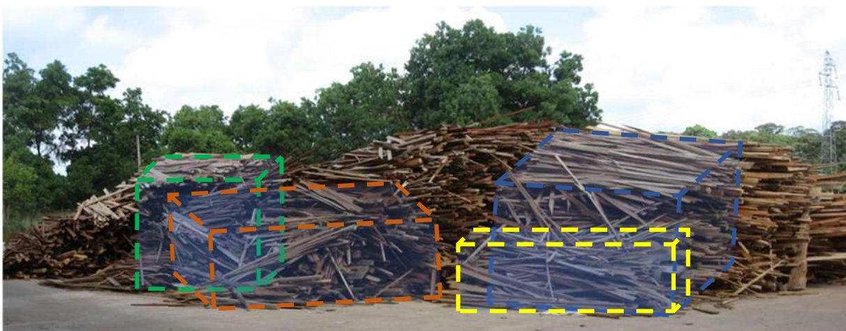
Figure 4 : approche du volume d'encombrement d'un lot de chutes de délignage
