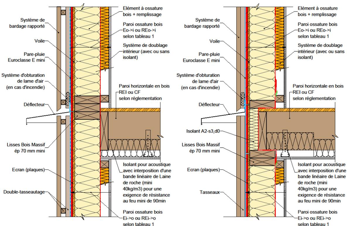
Figure 19 : Façade/mur ossature bois & plancher en ossature bois.
