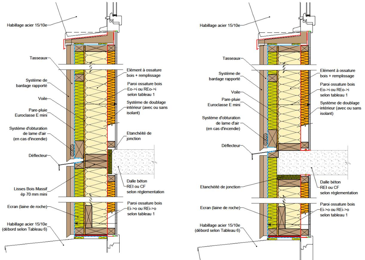
Figure 30 : Façade/mur ossature bois & plancher en béton.
