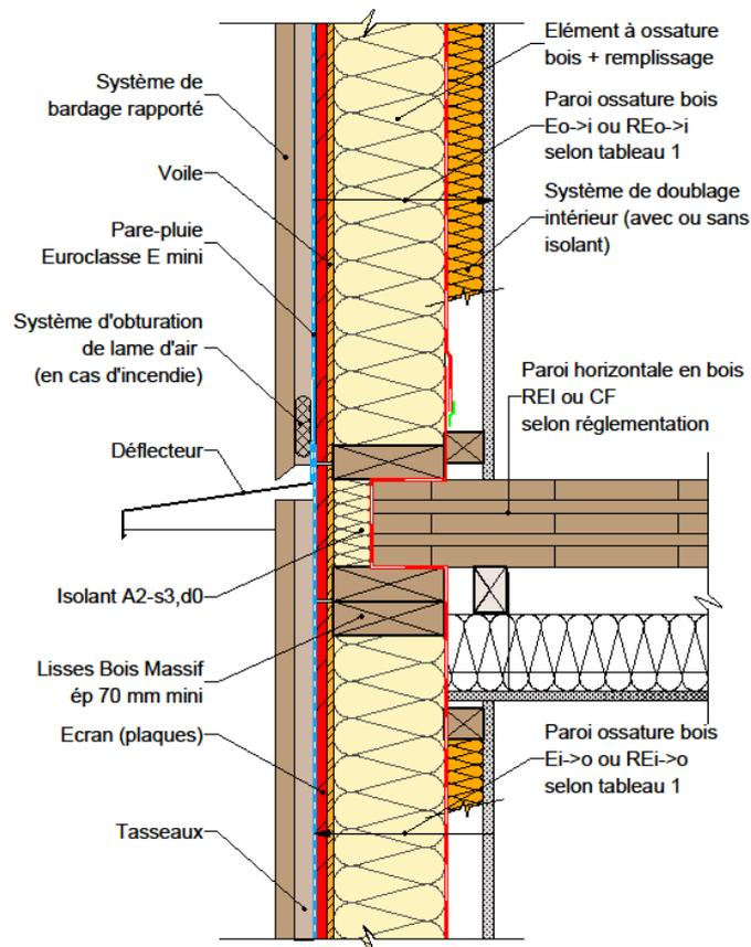
Figure 21 : Façade/mur en ossature bois & plancher en panneau bois massif.
