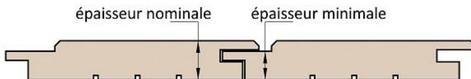
Figure 8: Epaisseurs des profils de bardage – Prescriptions.
