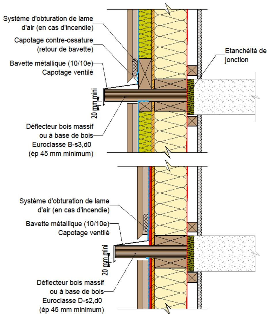
**Figure 12:** Défecteur en bois massif ou à base de bois dans le cas où l'écran thermique est réalisé en laine de roche entre ossature (figure du dessus) ou en plaque rigide A2-s3, d0 (figure du dessous).
