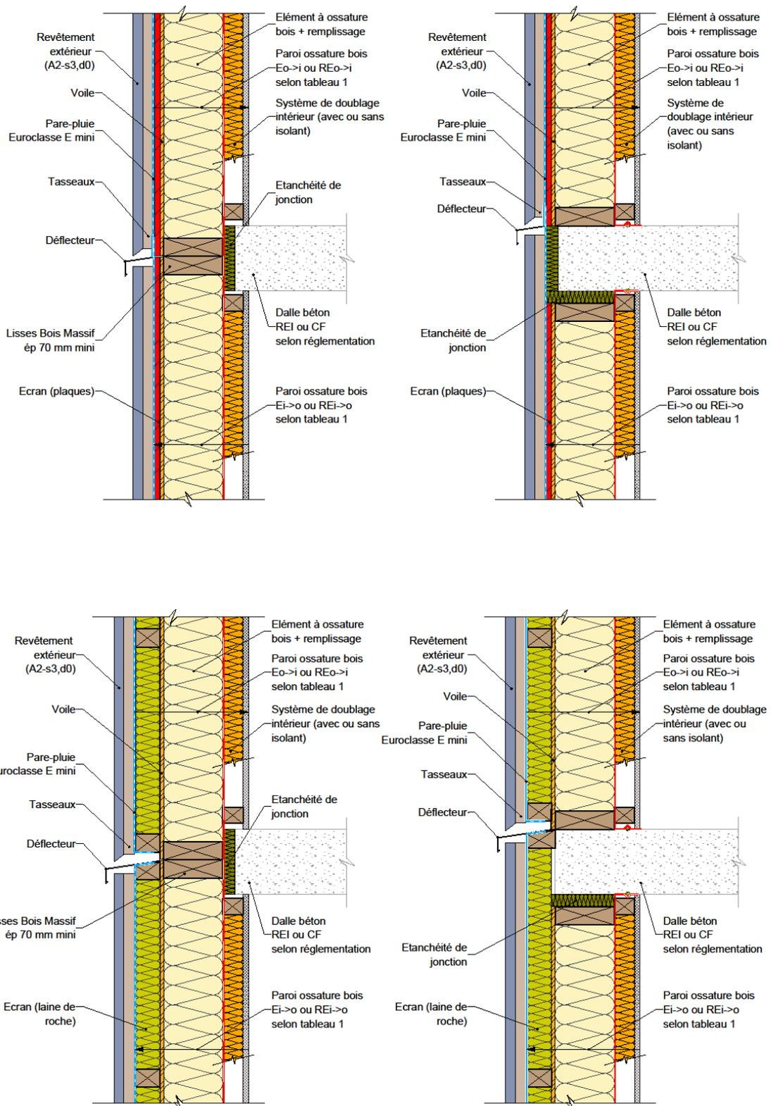
Figure 34 : Façade/mur en ossature bois & plancher en béton.
