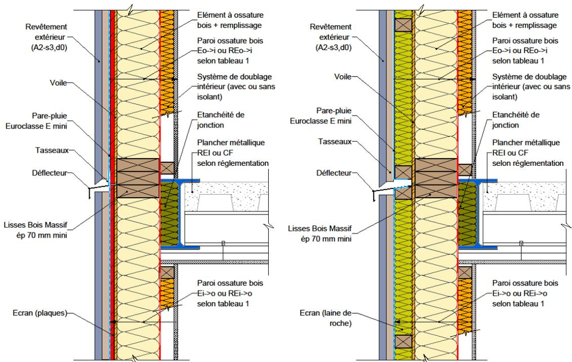
Figure 38 : Façade/mur en ossature bois & plancher métallique.
