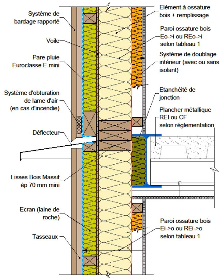
Figure 29 : Façade/mur ossature bois & plancher métallique.
