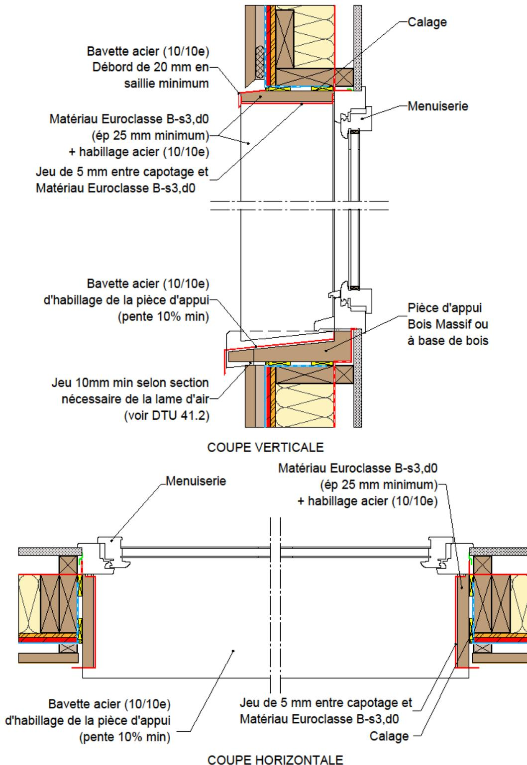
Figure 5: Traitement des embrasures de menuiseries avec un matériau B-s3, d0 + habillage acier.
