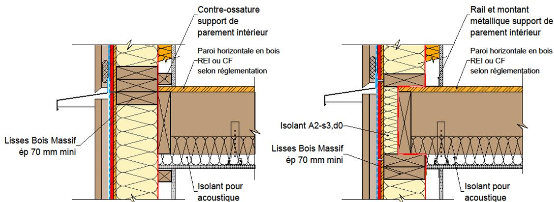
**Figure 3:** Traitement de l'étanchéité au nez d'un plancher bois avec doublage intérieur assurant l'intégralité de l'exigence  $E_{i \rightarrow o}$  requise et au moins égale à la performance du plafond (si la durée de résistance au feu de la structure est inférieure ou égale à 60 minutes).
