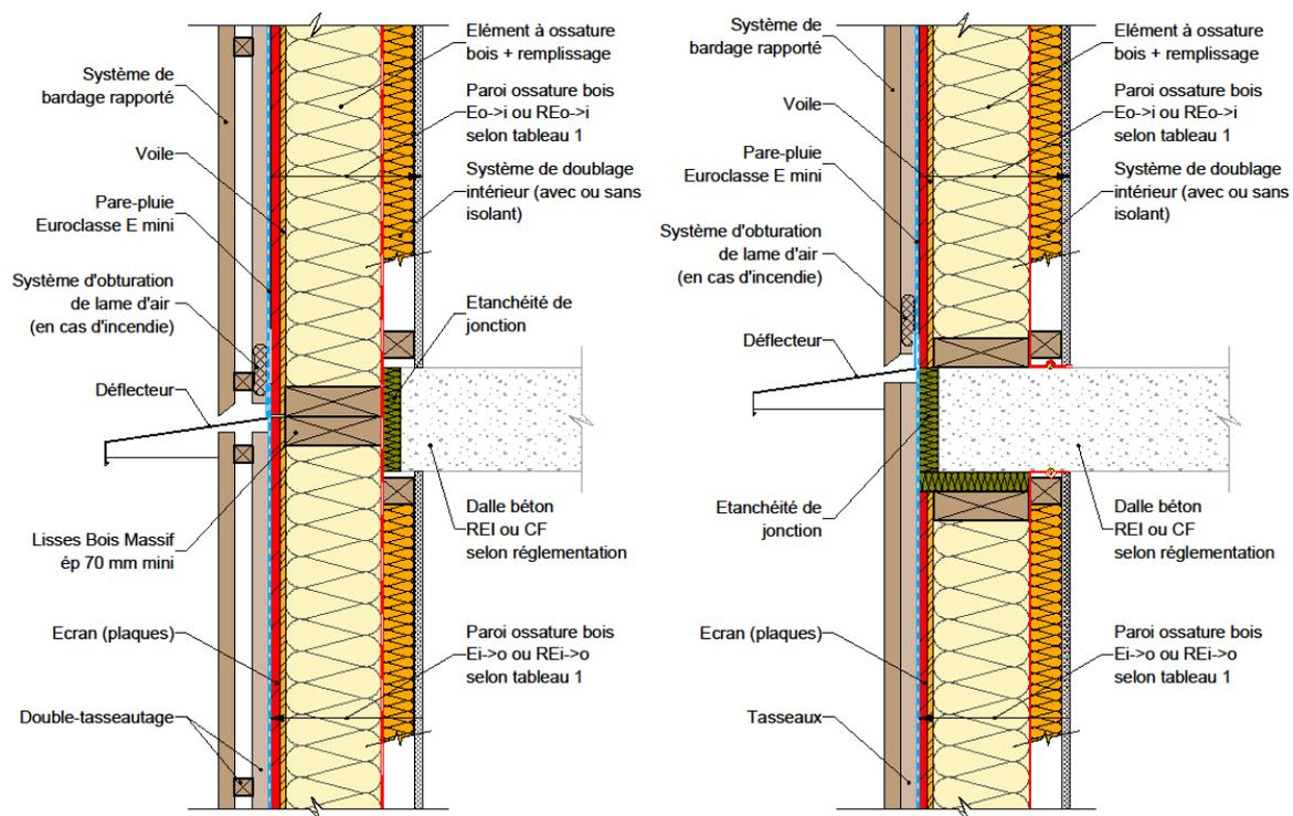
Figure 18 : Façade en ossature bois sur plancher béton.
