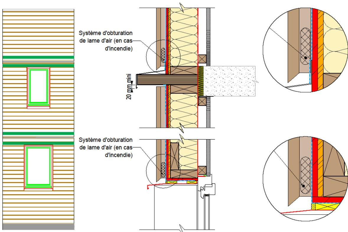
**Figure 10 :** Position des dispositifs d’obturation de la lame d’air si la durée de résistance au feu de la structure est strictement supérieure ou égal à 90 minutes avec un bardage ventilé dont la performance en réaction au feu du parement est soit de classe D-s2, d0 ou soit de classe C-s2, d0.
