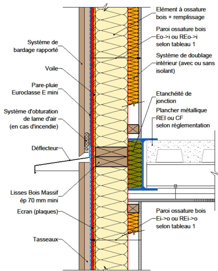
Figure 22 : Façade/mur ossature bois & plancher métallique.
