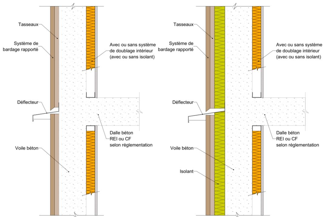
**Figure 39 :** Bardage ventilé avec revêtement extérieur à base de bois sur support en maçonnerie.
