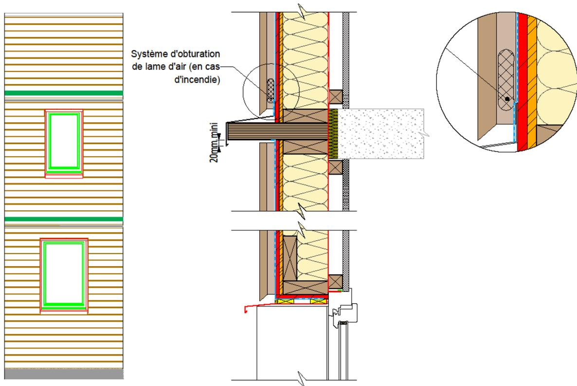
**Figure 9 :** Position des dispositifs d’obturation de la lame d’air si la durée de résistance au feu de la structure est inférieure ou égale à 60 minutes avec un bardage ventilé dont la performance en réaction au feu du parement est soit de classe D-s2, d0 ou soit de classe C-s2, d0
