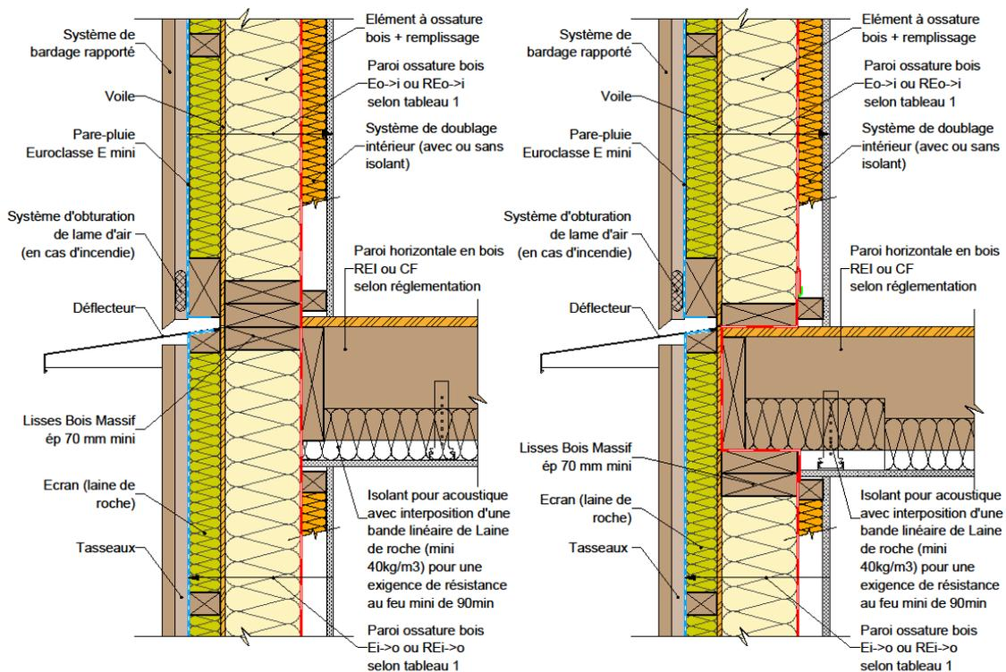
Figure 26 : Façade/mur ossature bois & plancher en ossature bois.
