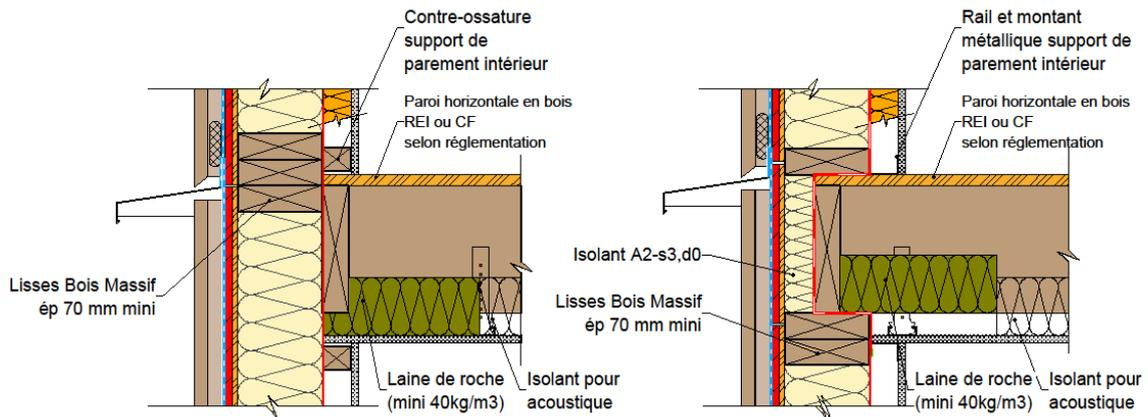
**Figure 4:** Traitement de l'étanchéité au nez d'un plancher bois avec doublage intérieur assurant l'intégralité de l'exigence Eli->o requise et au moins égale à la performance du plafond (si la durée de résistance au feu de la structure est supérieure ou égale à 90 minutes).
