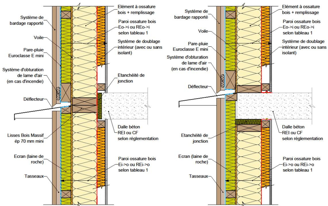
Figure 25 : Façade/mur ossature bois & plancher béton.
