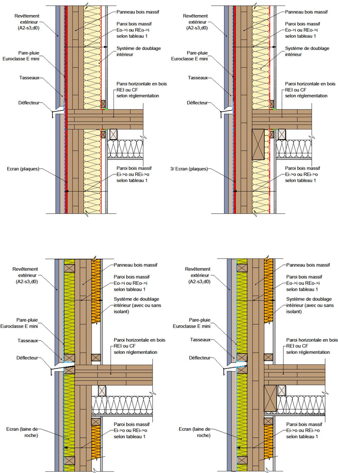
Figure 36 : Façade/mur en panneaux bois massif & plancher en panneaux bois massif.
