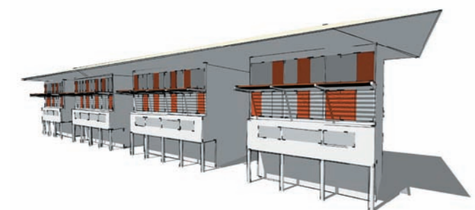
Le débord de toiture et les brises soleil protègent du rayonnement solaire chaque niveau du bâtiment.
