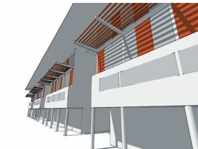
Le débord de toiture et les brises soleil protègent du rayonnement solaire chaque niveau du bâtiment.
