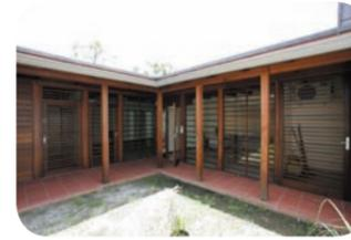
De grandes fenêtres favorisent l'éclairage naturel dans les bâtiments. Elles sont composées de lames fixes permettant de contrôler la lumière entrant dans les pièces.
