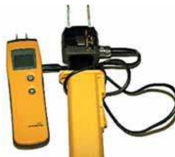
Fig. 55 - Humidimètre (méthode par résistivité).
