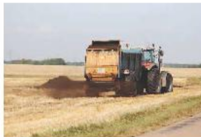
Photo n°4 : épandage possible des cendres et du fumier avec un épandeur à table d'épandage
