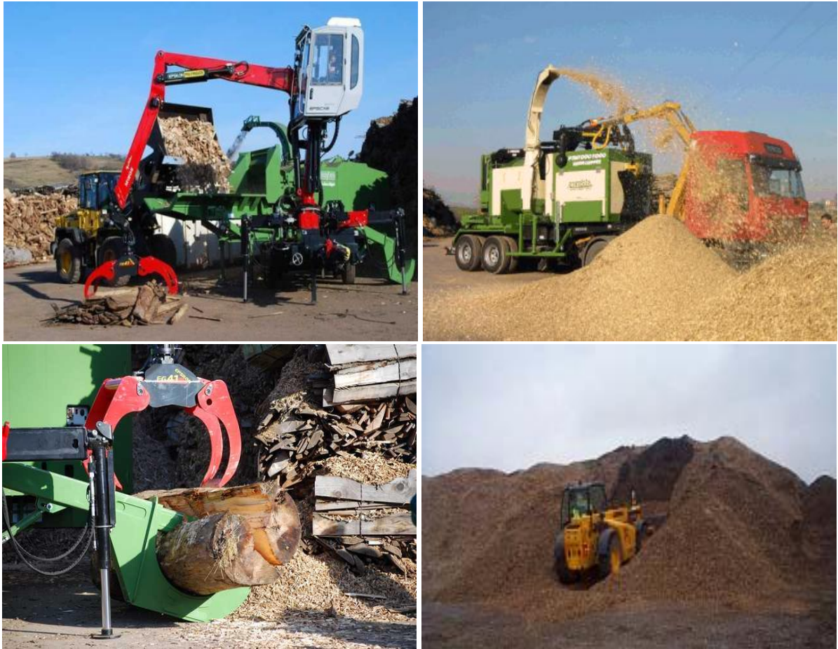
Photo 8: Exemples de broyeurs mobiles de grandes capacités (moteur diesel de 420 à 480 CV). Déchiqueteuse à tambour "spécial plaquettes forestières et chargement à la brassée et à la grue" - Pour grosses productions. " Production horaire théorique en bois type européen : de 100 à 150 m3
