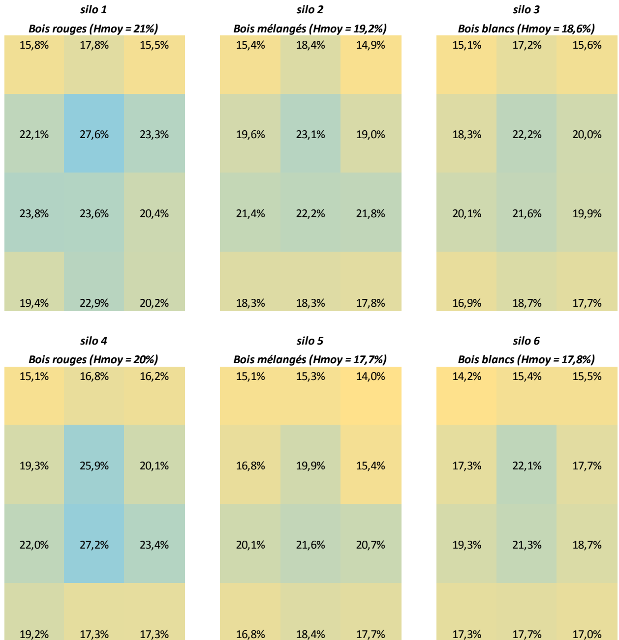
Figure 10 Distribution de l'humidité sur masse brute à l'intérieur des 6 Silos en fin d'essai
